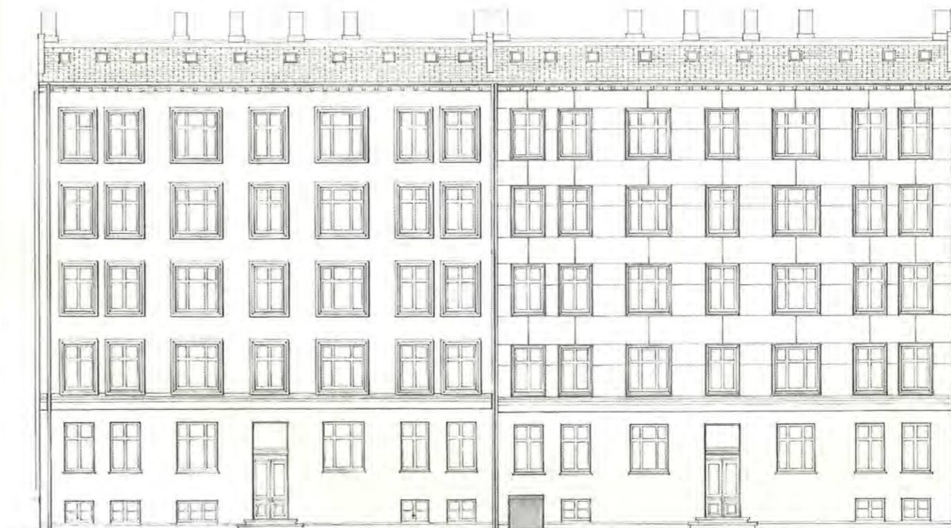
Figur 2. Gadefacade efter isolering.
